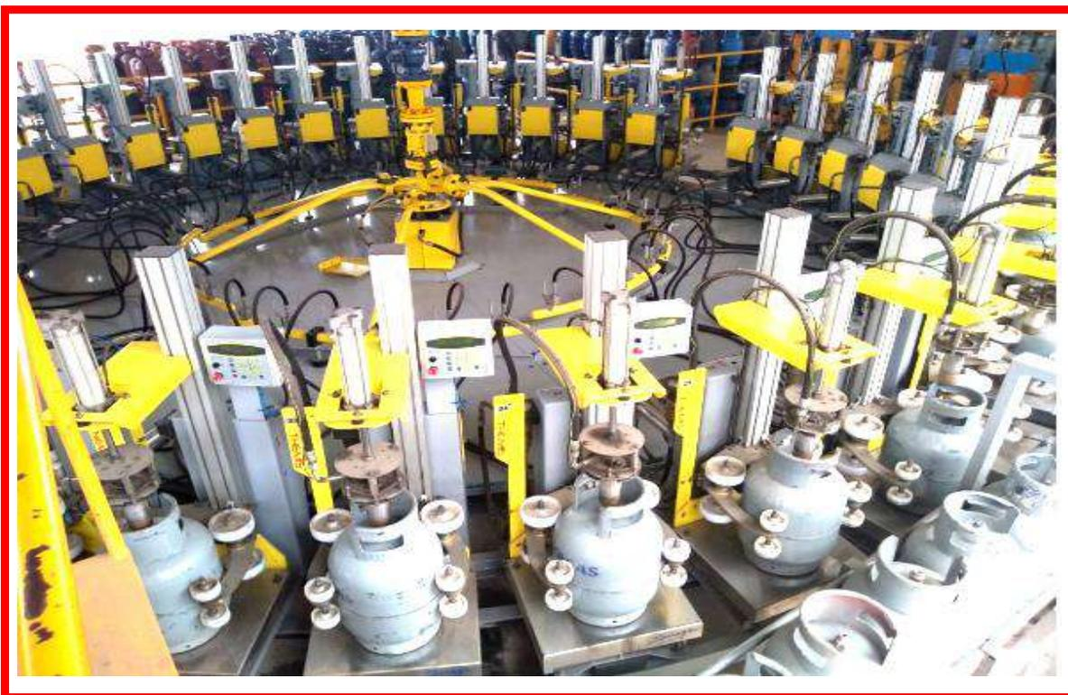
Foto 11. Vista aérea de la Rueda de SIRAGA de 36 Balanzas y Basculas de Llenado.
