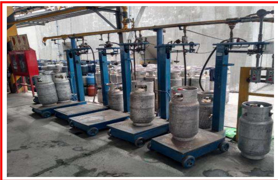
Foto 19. Se observa las seis (06) balanzas en la zona de llenado con GLP a los cilindros de 15 Kg.
