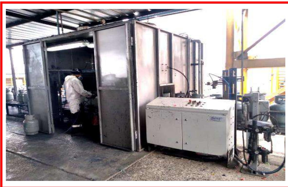
Foto 20. Se observa la Cabina de Pintado SIRAGA de los cilindros que posteriormente se llenan con GLP.
